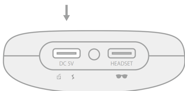
図4-2 MoonWalker本体は必ず右側「HEADSET」端子へ接続します。左側「DC 5V」は充電専用です。
